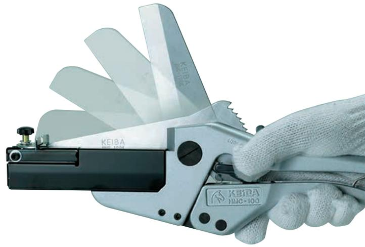
片手で操作できるワンタッチ開口式のプロテクターモールカッターとダクトカッターです。モールカッターは直角・斜め45°を正確に切断可能。ダクトカッターは2枚切りも楽々出来ます。安全ストッパーを解除しない限り開かない安全設計です。
