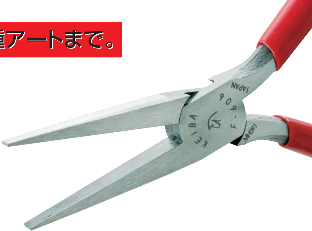
弱電、金工その他工芸関係に利用できる大変便利な工具です。先端を酷使に耐えるようラジオペンチ同様シビアな熱処理管理を行います。内面は写真でお判りの通り、横筋を入れず加工物を傷付けない配慮をしています。
