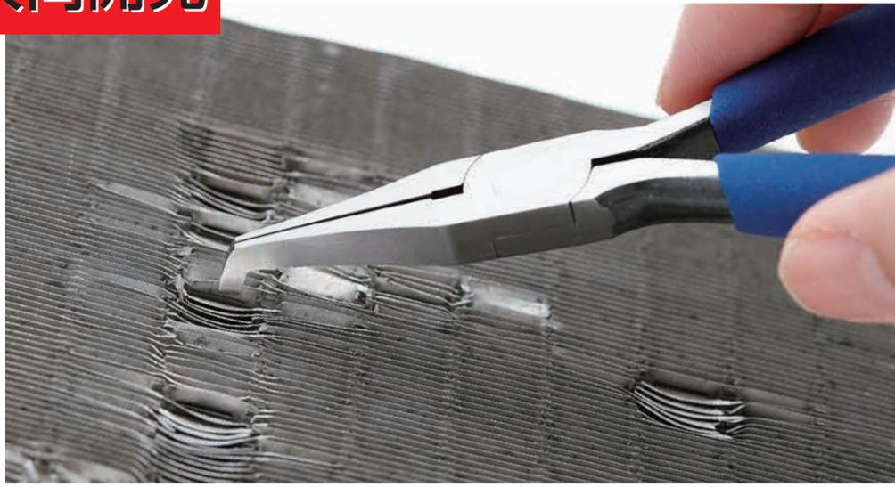
小石などが当たって潰れた車やバイクのラジエーターフィン簡単に修正出来る専用工具です。日本のレース界の名門「チーム ルマン」のメカニックと協力して開発しました。狭いフィンの間にも容易に差し込む事が出来、しかも傷付けることなくしっかりとつかむ事が出来ます。ノーズの角度やグリップのサイズも調整し、連続作業による負荷を軽減しました。現在、実際にプロのレーシングチームで使用されている本格ツールです。
