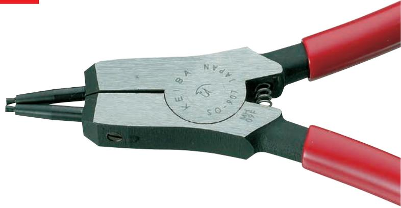
C型スナップリングの着脱用工具です。軸用(EXTERNAL)と穴用(INTERNAL)の2種類があり、用途に応じて直・曲のクローを交換できます。クローの先端をバックテーパ加工し、リングを確実にキャッチできる配慮は他と大きく異なる特長の一つです。先端クローは平も用意してあります。クロー部の材質は強靱な高級特殊鋼(SKS-3)を使用しています。
